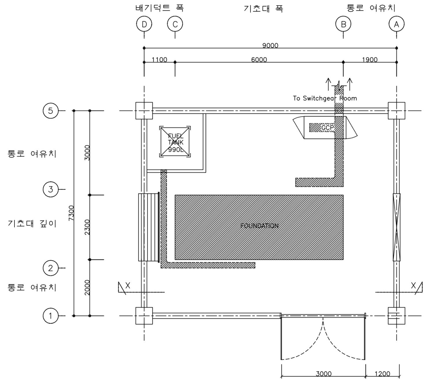
① 발전기실 FOUNDATION, TRENCH 설비 평면도
